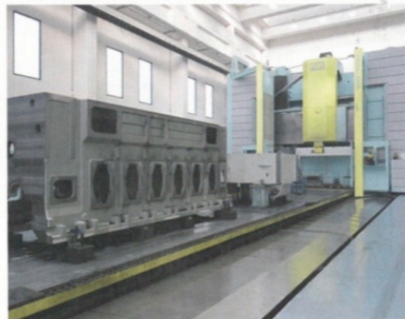
Il centro di lavoro Vertiram di Pama presenta corse degli assi X (portale), Y (testa), Z (ram) e W (traversa) rispettivamente di 22.000, 5.000, 3.000 e 5.100 millimetri
