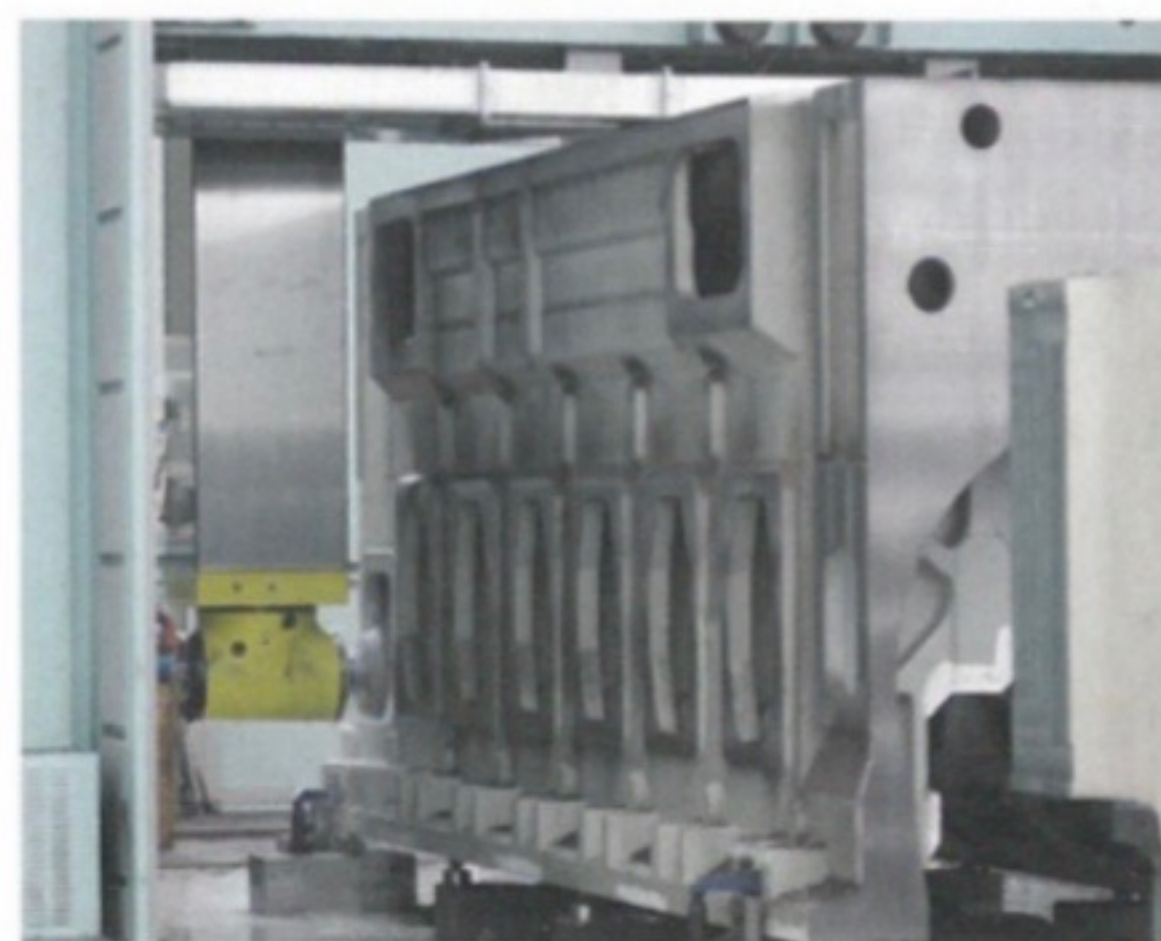
La macchina è dotata di magazzino utensili a catena di 150 posti e di 5 teste di lavoro, studiate da Pama per la lavorazione dei blocchi motore con sistema automatico di cambio teste
